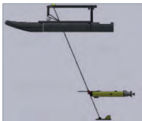
(a) 绳索捕捉式水下回收示意图
