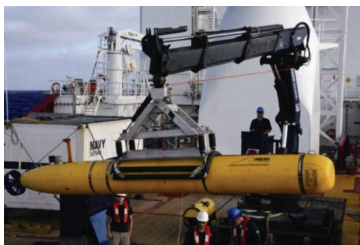
(a) Bluefin-21 吊装示意图
