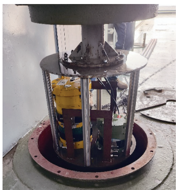
图3 ADCP 月池安装图
