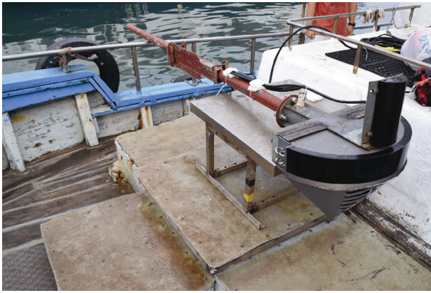
图6 T-sea CMBS200 在线多波束声呐 Fig.6 T-sea CMBS200 online MBES
