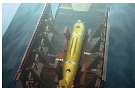
图 5 典型坞舱式搭载示意图
