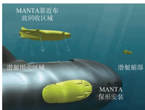
图6 典型背负方式搭载示意图
