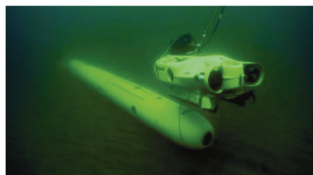
图9 ROV有缆捕获方式示意图
