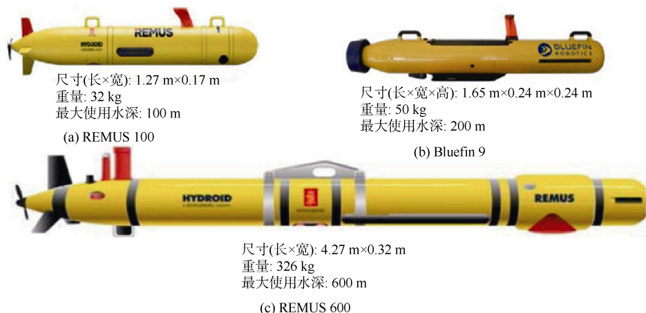
图3 反UUV能力演示项目使用的UUV目标
