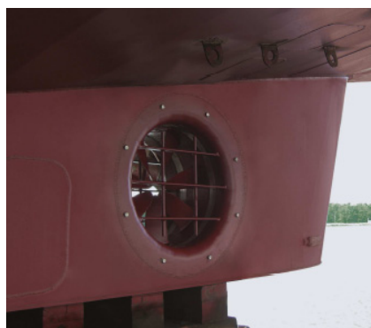
图 16 安装在船艉的 VIT Fig. 16 VIT installed at stern
