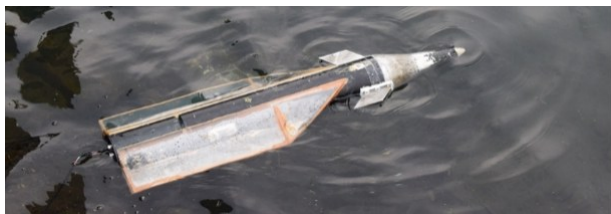
图2 滑跳模型静浮于水面时状态
