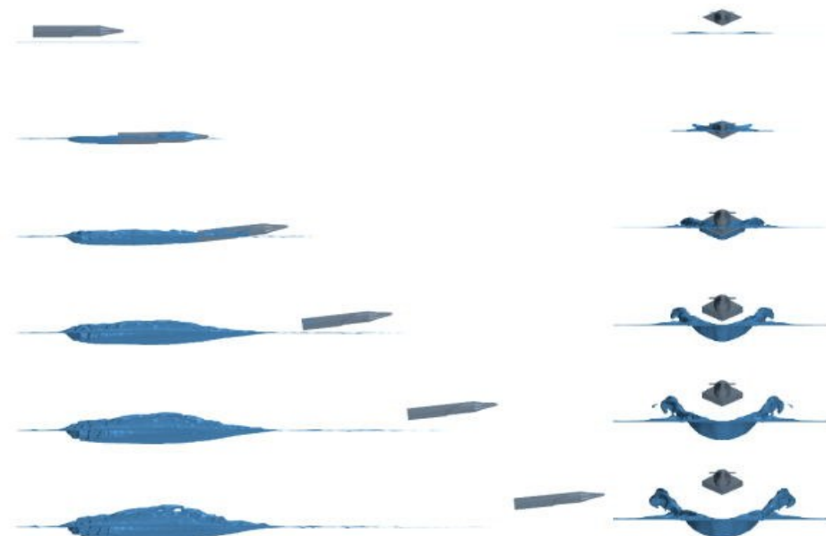
图 5 模型水面滑跳过程仿真结果
