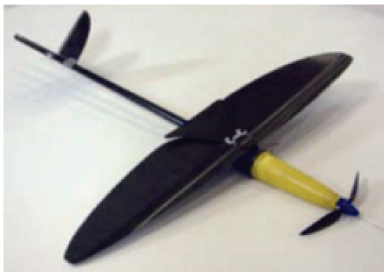
(c) 刚性折叠翼跨介质航行器
