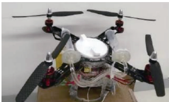
(a) 多旋翼跨介质航行器
