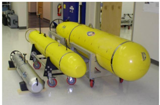
图 2 构成 CADRE 系统的 3 类 UUV
