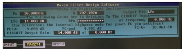
图 4 二阶滤波单元参数设置界面
