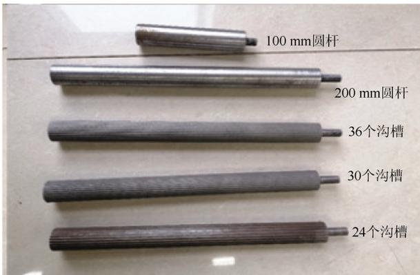
图 9 加工零件示意图
