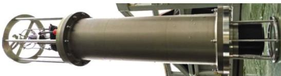
图3 IBFD-UWA通信工程样机
