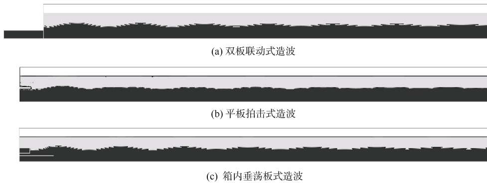
图 3 某时刻周期内波波面形态 ( h_2=0.40\text{ m} , h_1=0.35\text{ m} )
