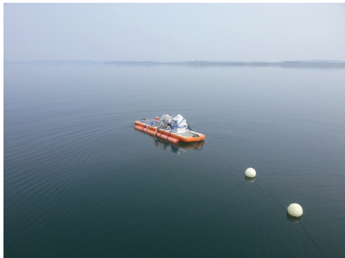
图 13 采用波浪模拟试验装置的“海鳐”波浪滑翔器湖上性能试验
