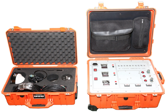
图 12 “海鳐”波浪滑翔器的便携式岸站系统
