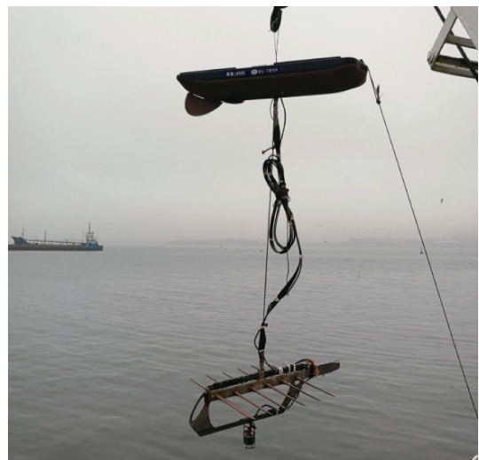
图 8 搭载声学系统的“海鳐”波浪滑翔器 Fig. 8 “Sea Ray”wave glider with acoustic system
