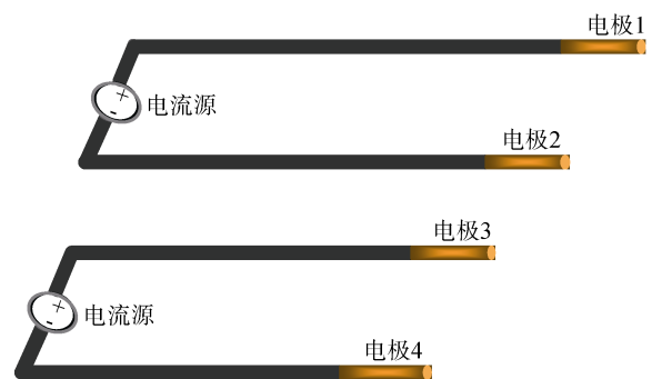
图1 电极阵电磁扫雷具示意图
