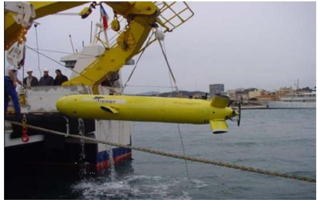
图 4 探索者 AUV 回收
